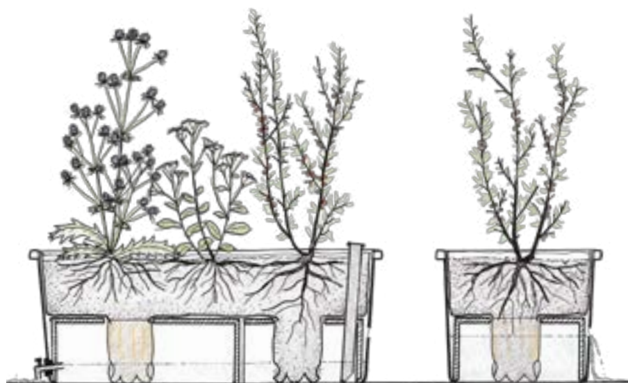
Konceptsnit af kapilærkassen, princippet kan bruges i hvilken som helst beholder.
